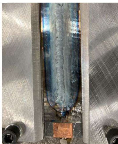
図 6. 薄板溶接用治具(TIG 溶接)
