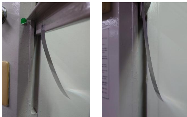
図 3. メッキテープを用いた開口高さによる風速変化の可視化 開口高さ 30 cm (左)、開口高さ 90 cm (右)
