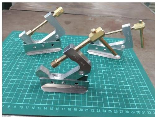
図 2. 製作物(フレーム:A5052, 送りねじ:真鍮)
