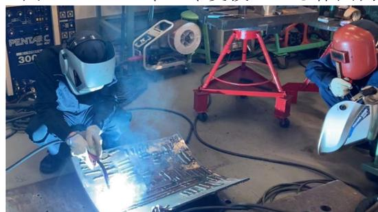
図 2. MIG 溶接法指導風景
