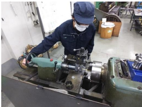
図 5. シャコ万力の送りねじの加工作業
