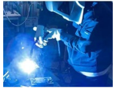
図 5. MIG 溶接のスプレー移行
