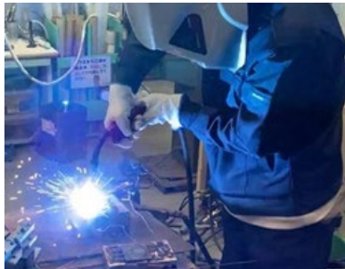
図 4. MIG 溶接の短絡移行
