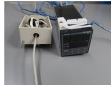
図1.デジタル指示調節計(TTM-104)
