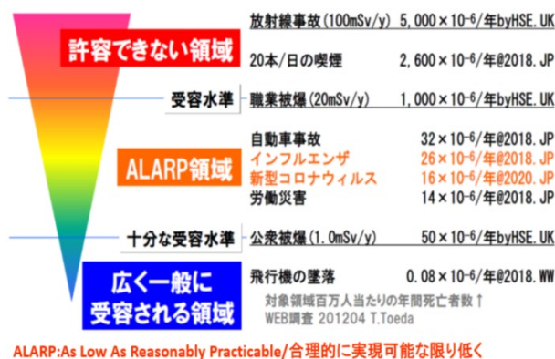
図2 許容可能なリスクの例 (出典:JSME ICMS 安全入門ゼミナール資料)
