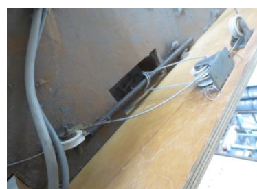
図3. 滑車交換作業
