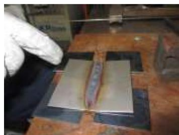
図 12 SUS 板の溶接後
