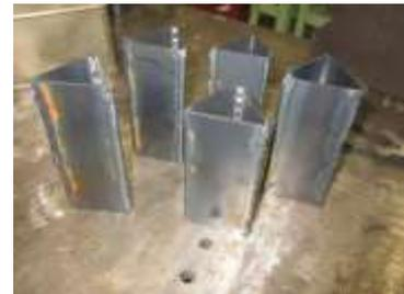
図8 製作した三角柱
