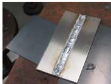
図 14 アルミ板の溶接後
