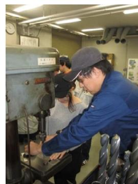
図 3 ボール盤作業
