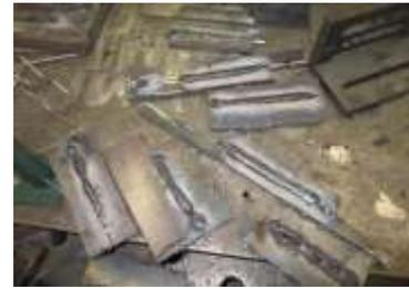
図4 突合せ継手と重ね継手の練習
