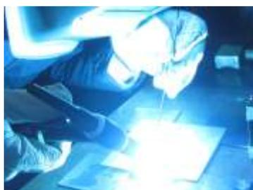
図 13 アルミ板の突合せ継手
